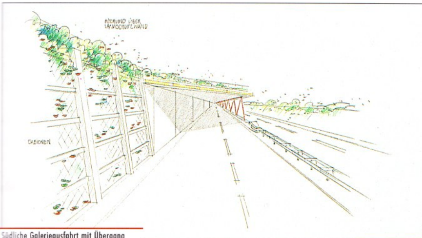
Südliche Galerieausfahrt mit Übergang zur Stützmauer.
